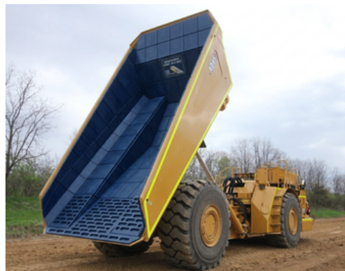
UHMW PE Superlining muestra la mejor propiedad de deslizamiento.
